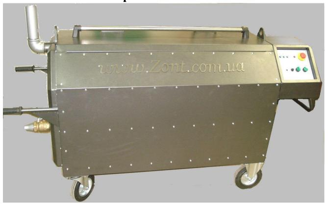
**Б**итумный нагреватель отвечает самым высоким требованиям дизайна, эксплуатации. Изготовлен в соответствии с современным уровнем техники и безопасности при эксплуатации. Предназначен для электронагрева, перемешивания, смешивания с другими ингредиентами жидкого битума.
